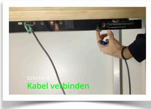
Monitor über HDMI (Zugentlastung verwenden)
