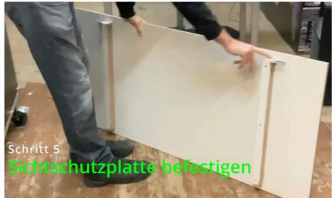
Frontplatte anbringen (Torx 40), Schrauben in kleiner Tupperbox
